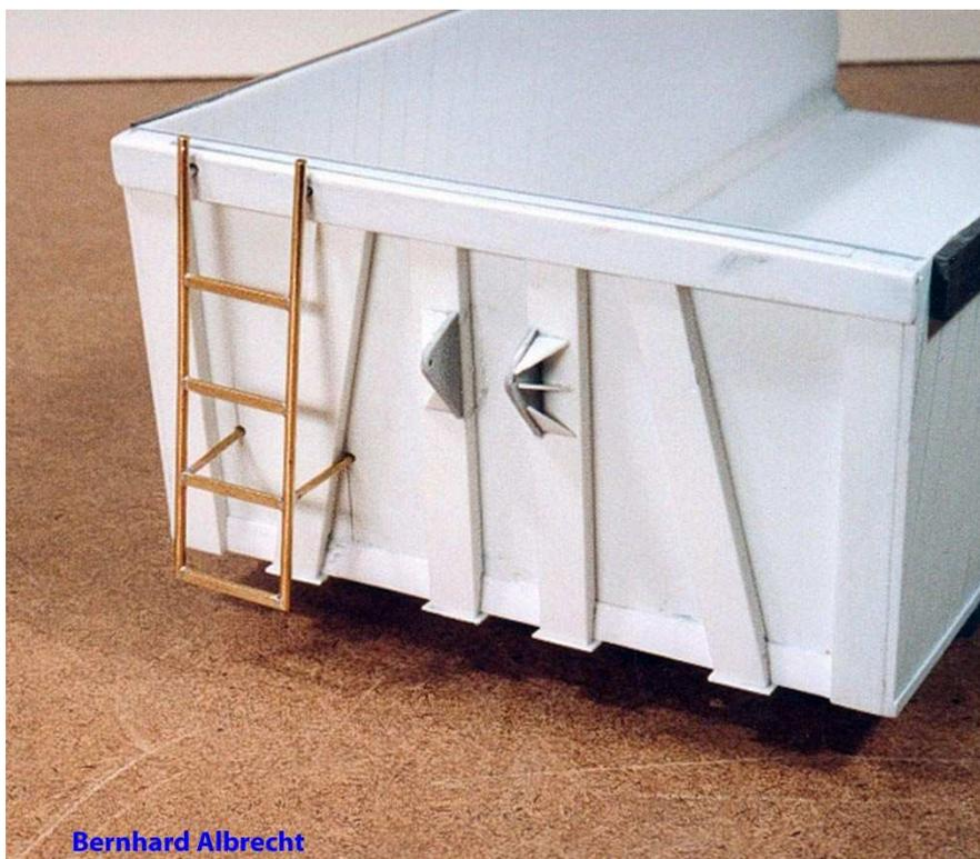
wurden die Seitenteile an den Muldenboden und die Stirnwand angeklebt, und zwar so, dass die Seitenteile der Mulde etwas über 3mm über die Stirnwand nach vorne überstehen. In diese Nische wurde ein Evergreen-Profil 6,3x3,2mm als Verstärkungsrunde geklebt. Aus dem gleichen Material wurden auch weitere Streben auf der Stirnwand nachgebildet: Die beiden senkrechten
