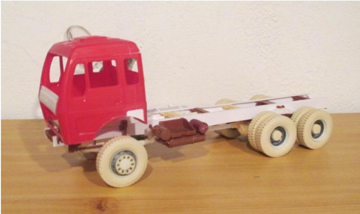
Die Fahrerhausinneneinrichtung wurde aus verschiedenen Bausatzteilen zusammengeklebt, auf dem Motortunnel wurde noch eine Konsole für den Schalthebel aufgeklebt, die drei kleinen Schalter für die Differentialsperren, der Schalter für den Nebenantrieb und der größere Drehknopf für den zuschaltbaren Allradantrieb ergänzt
