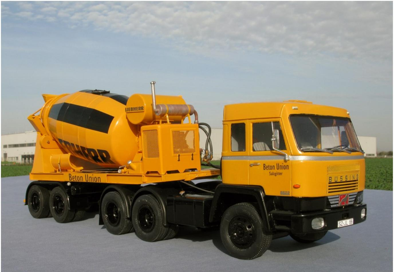
Bild 1) Büssing BS 22 Sattelmischer
